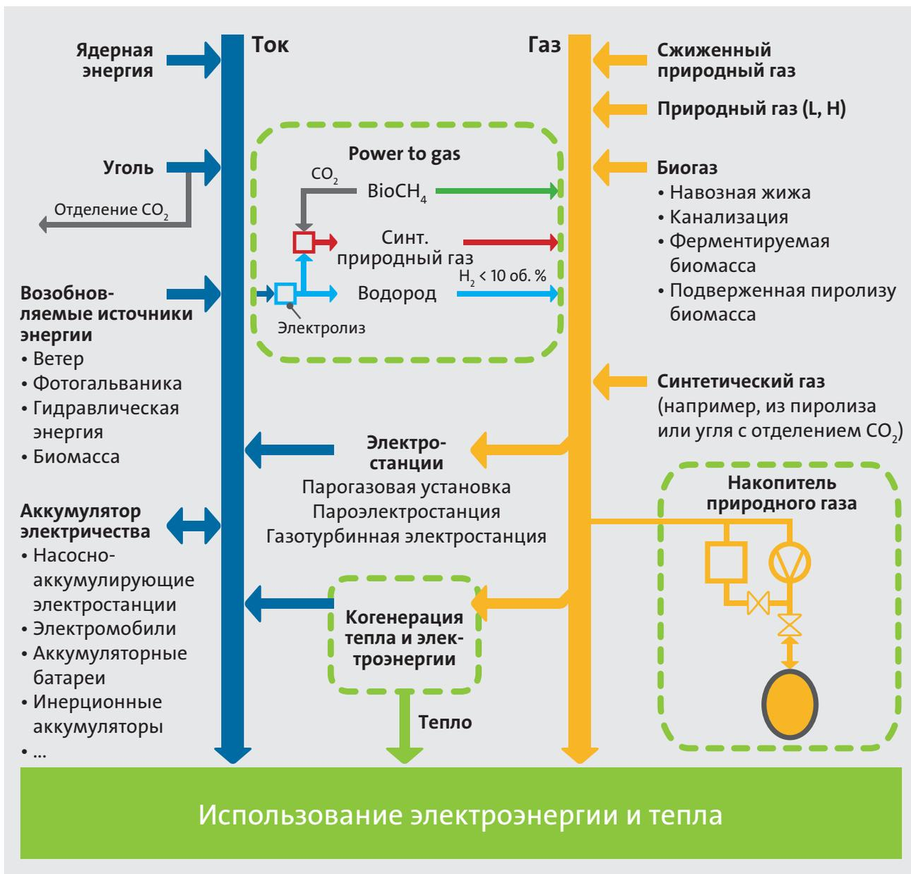
Рис. 103: Синергия электрической и газовой сети
