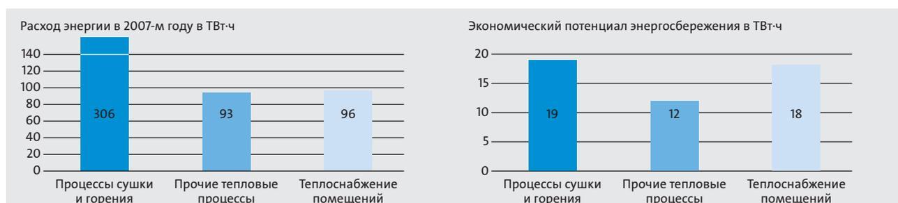
Рис. 99: Энергопотребление и потенциал энергосбережения при промышленном применении технологического тепла
